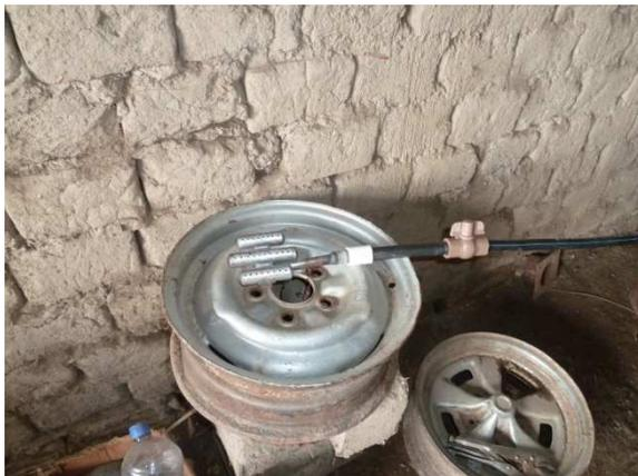
**Ilustración 1.dd: Cocina con quemador de 3 líneas. Falta todavía el soporte. (9)**
