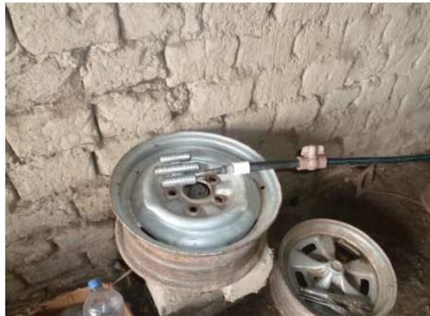
Ilustración 1.j: Cocina de biogás con llanta y quemador de 3 líneas
