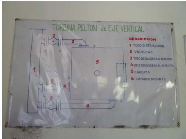
Ilustración 3.a: Esquema de la turbina Pelton (11)
