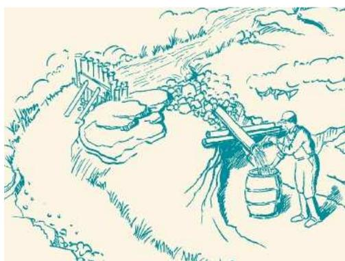
**Ilustración 2.l: Método del balde (6)**
