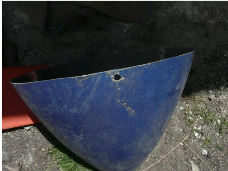
Ilustración 2.k: Cono de protección (resina con fibra de vidrio) (8)
