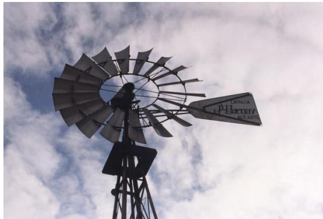
Ilustración 2.d: Aerobomba con turbina lenta<sup>10</sup>
