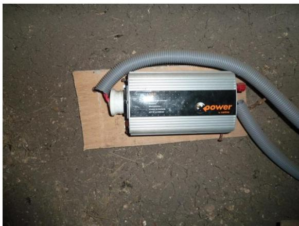
Ilustración 2.v: Inversor 12V CC/230V CA de marca Xantrex, potencia 300 W, en El Alumbre
