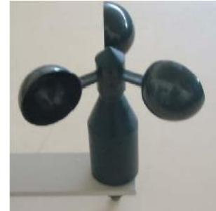
Ilustración 2.z: Anemómetro de cazoleta (27)
