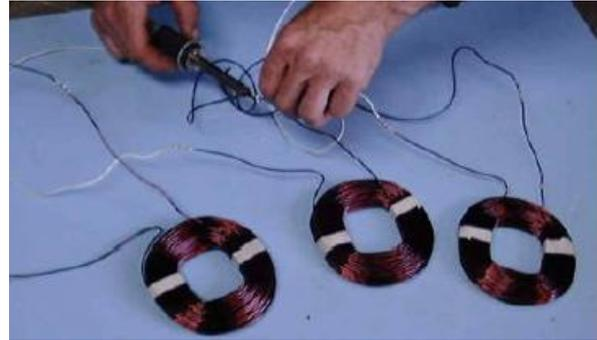
**Ilustración 2.g:** Bobinas para el estátor (12)
