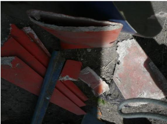
**Ilustración 4.b: Elementos de palas rotas (8)**
