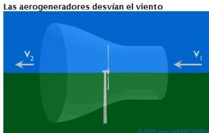
Ilustración 1.b: Desviación del viento por un aerogenerador. En el caso ideal,  $v_2 = \frac{v_1}{3}$  (2)
