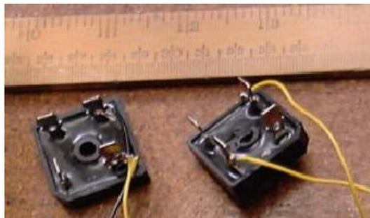
Ilustración 2.m: Foto de 2 diodos rectificadores (12)
